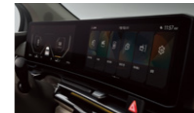
슈퍼비전 클러스터 (12.3인치 풀사이즈 칼라 TFT LCD)
