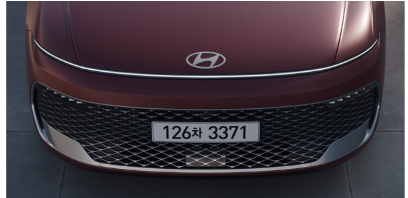
수평형 LED 램프(심리스 호라이즌 램프 - 주간주행등, 방향지시등, 포지셔닝 램프)
